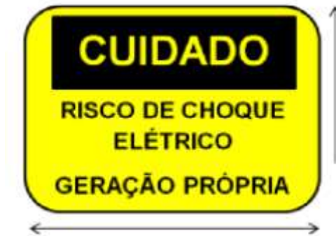
Figura 3. Placa de advertência de geração própria. Dimensões: 25cm x 18cm.
